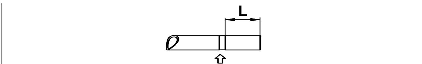
Длина вводимого участка и усилие, прилагаемое при вставке труб, зависят от диаметра труб и конструкции соединения. Соответствующие показатели для соединений RO и P5 приведены в следующей таблице.
