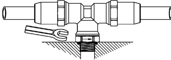
Перед монтажом нужно проверить расположение уплотнительного кольца на резьбовой прокладке. Уплотнительное кольцо нужно заменить, если оно повреждено.
