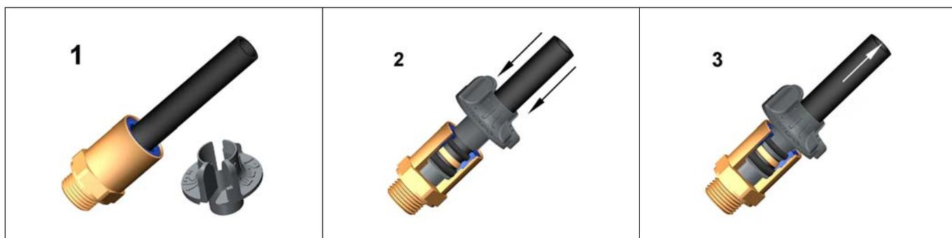
Резьбовое соединение можно продолжать использовать и через несколько лет, если не затвердела прокладка. Проверка герметичности проводится в любом случае.
